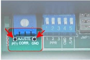
**Figura 7:** Posição dos pontos de medida
