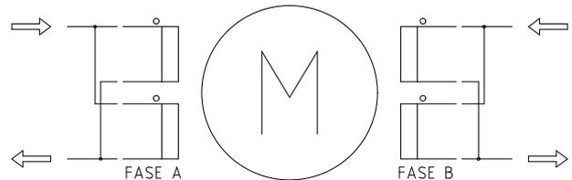
**Figura 13:** Motor 8 fios em paralelo
