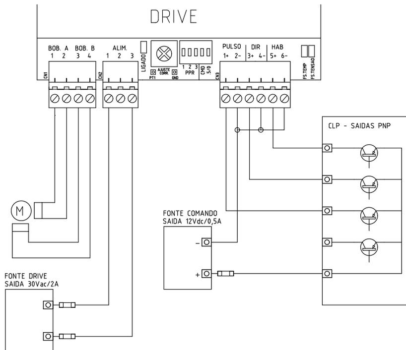
**Figura 20:** Ligações usando CLP com saídas PNP
