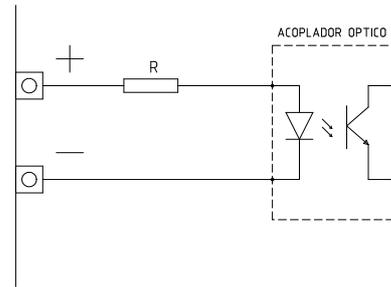
**Figura 16:** Interface elétrica das entradas
