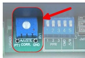
**Figura 6:** Potenciômetro de ajuste da corrente
