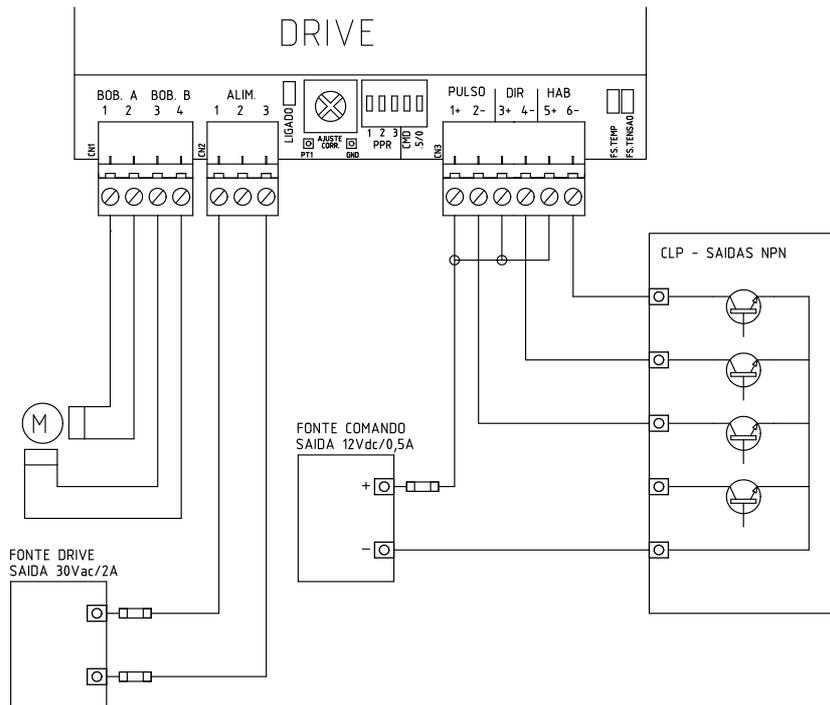
**Figura 19:** Ligações usando CLP com saídas NPN
