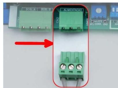
Figura 2: Conexão de Alimentação
